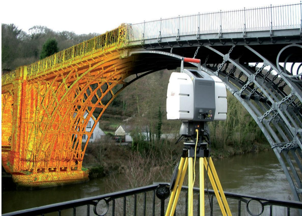
Установка лазерного сканирования.
